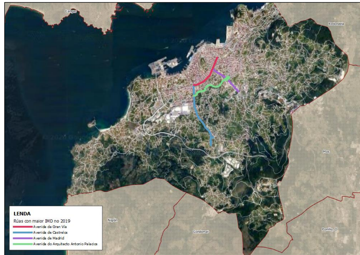
Figura 157: Vías onde se sitúan os puntos de medición municipais con maior IMD (veh/día) durante o ano 2019
